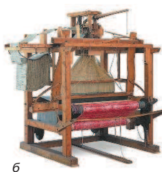
Рис. 10 Автоматические устройства с программным управлением а) Барабан с программой для пианолы (XIX в.) б) Цепь перфокарт с программой для ткацкого станка Жаккарда (XIX в.)
