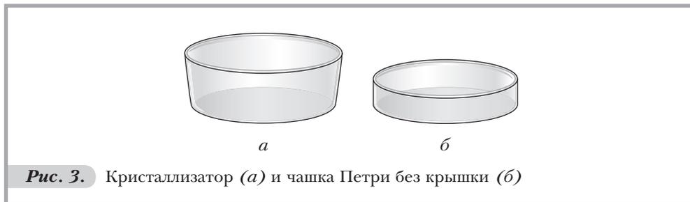
**Рис. 3.** Кристаллизатор (а) и чашка Петри без крышки (б)
