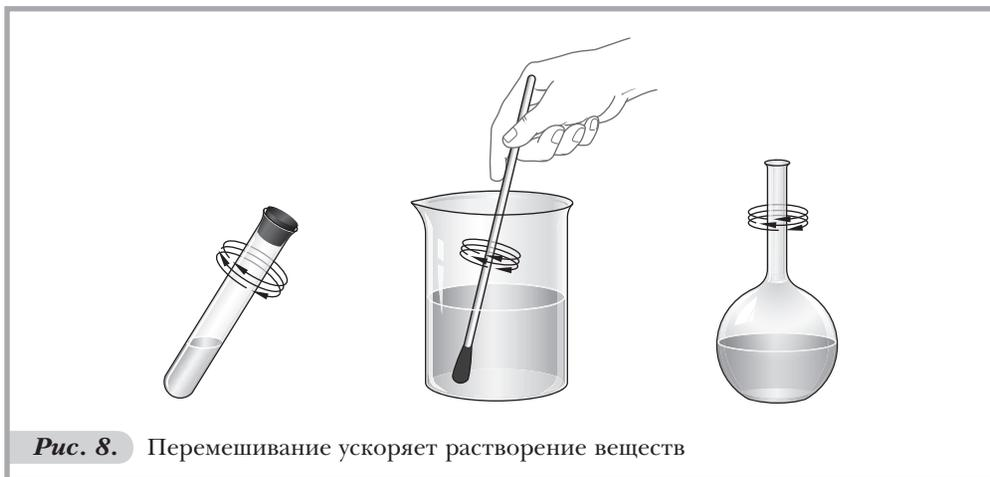
**Рис. 8.** Перемешивание ускоряет растворение веществ
