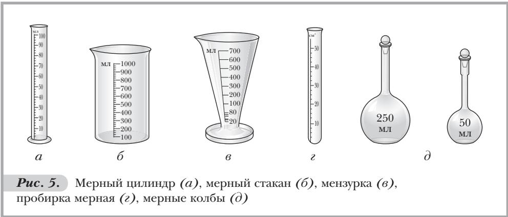
**Рис. 5.** Мерный цилиндр (а), мерный стакан (б), мензурка (в), пробирка мерная (z), мерные колбы (д)
