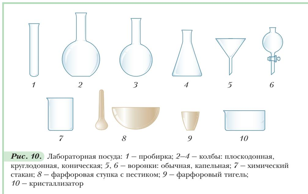
**Рис. 10.** Лабораторная посуда: 1 – пробирка; 2–4 – колбы: плоскодонная, круглодонная, коническая; 5, 6 – воронки: обычная, капельная; 7 – химический стакан; 8 – фарфоровая ступка с пестиком; 9 – фарфоровый тигель; 10 – кристаллизатор
